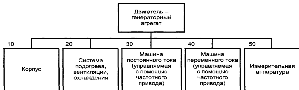
Рисунок В.2 - Диаграмма подсистем двигателя-генератора
